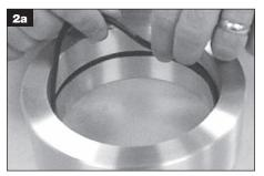
O anel de poliuretano é levemente deformado para se encaixar no equipamento.
