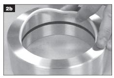
Para encaixar no alojamento do equipamento, o anel feito de material PTFE modificado deve ser levemente deformado. Deve-se cuidar para não deformá-lo excessivamente.
