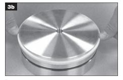
Para encaixar no alojamento do equipamento, o anel do pistão feito de material PTFE modificado deve ser levemente esticado. Os materiais de PTFE modificados devem ser comprimidos no alojamento uniformemente. Deve-se cuidar para não esticar de forma inconsistente ou demasiadamente.
